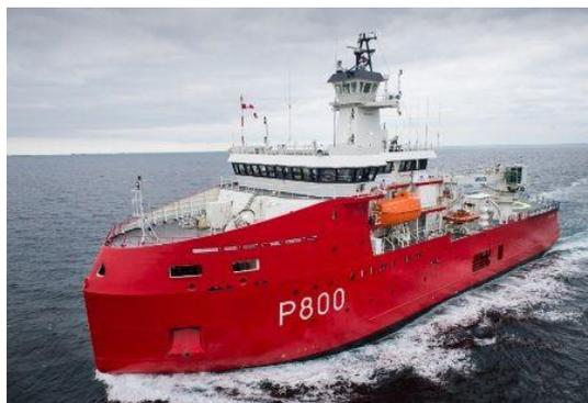
包和用于所有主机的瓦锡兰 NOR(氧化氮减排)SCR(选择性催化还原)废气清洁系统。设有大型直升机甲板，可服务 2 架直升机，船上配备了 4 台 IMO Tier III 认证的 8 缸 W ärtsil ä20 柴油机，2 台可调螺距螺旋桨和包括 W ärtsil ä减速齿轮、W ärtsil äNOR 系统的轴线和 1 台 W ärtsil ä隧道推进器。
