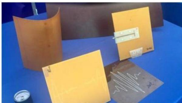
通道系统，可以根据所需的频率和方向进行重新配置天线，并在 70 兆赫到 7 吉赫的频率范围内进行了测试。使用的液态金属为镓，其熔点为 30 摄氏度，通过添加钢等其他金属形成合金，可使熔点降到-28 摄氏度。这种通道系统可以采用柔性结构进行集成，形成柔性混合电子系统。
