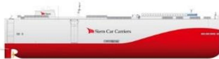
输船建造与设计合同生效。该船为超巴拿马型汽车滚装船，采用 LNG 燃料驱动。该船型对快速性、稳性要求高，货舱和 LNG 系统的布置空间紧凑。上船院设计团队以独特的设计，克服了货舱区内 2 个巨大的 C 型 LNG 罐对船舶浮态和破舱稳性带来不利影响，满足了船东对船舶在限定吃水下装载特定大众车型出港时的指定浮态要求。
