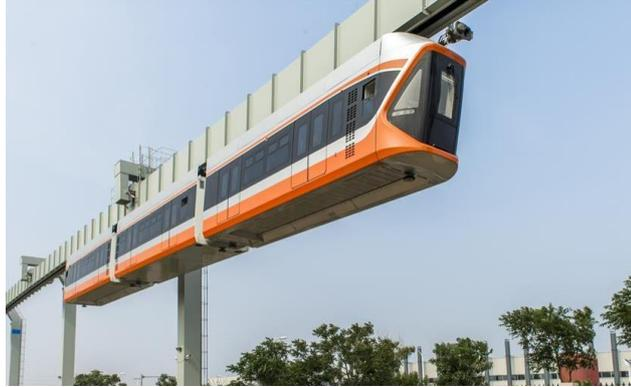
悬挂式单轨列车又被称为“空轨”“空中列车”，车底距离地面5米以上，最高可距离数十米。中车青岛四
