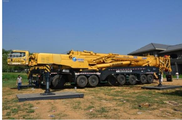
八节单缸插销伸缩臂，由超高强度钢材制造而成的吊臂，具备安装约2.5兆瓦风电的能力。同时，XCA1200可通过模块组合变化成通用机型与风电机型，用户可选装固定副臂、塔臂。配合徐工成熟的超起组合臂技术，可有效减少起重机臂变形，使整机起重性能和安全性能得到大幅度提升。
