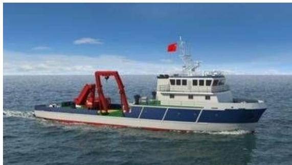
舩线型、倾斜船艏、方艉，单层底，主甲板为连续甲板，长艙楼，钢质焊接结构。该船满载排水量约 1000 吨，定员 23 人(其中研究人员 12 人)，续航力不小于 2000 海里，自持力不小于 30 天，适应于近海航区。
