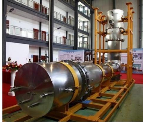
磁体馈线系统是 ITER 大型超导磁体系统供电、冷却和提供诊断信号的关键集成通道,被称之为 ITER 主机的生命线。该系统也是 ITER 部件中最为复杂的系统之一,包含 31 套不同的馈线,共计 6 万余个部件,总重超过 1600 吨,本次研制成功的部件就是该系统部分。
